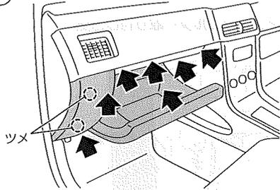
グローブボックスを開き、ネジ（7箇所）をドライバーなどで取り外し、グローブボックスを取り外してください。
