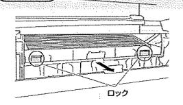
ロック(2箇所)を押し、上に持ち上げてから手前に引き抜きフィルタートレーを取り出してください。
