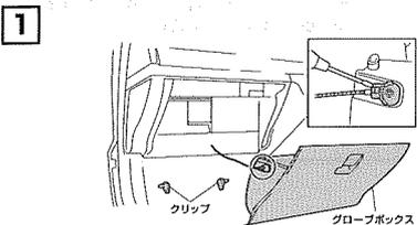
1 グローブボックス下側のクリップ (2箇所) を抜いてグローブボックスを取り外し、ダンパーをマイナスドライバー等を使用し取り外してください。
