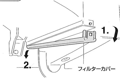
ツメ (1箇所) を外し、フィルターカバー (再使用します) を取り外してください。
