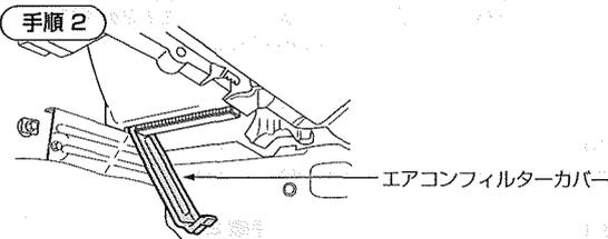
ツメ (1箇所) を外し、エアコンフィルターカバー (再使用します) を取り外してください。
