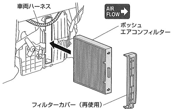
ボッシュエアコンフィルターを「Air Flow」の矢印が右を向くようにし、ハーネスをキズつけないよう注意して挿入してください。
