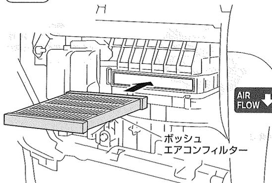
ボッシュエアコンフィルターを「Air Flow の矢印」が下を向くよう挿入してください。
