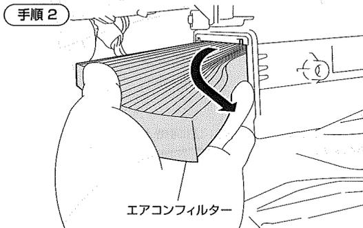
古いフィルターを図のように変形させて手前に引き、取り出してください。
