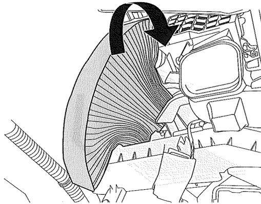
フィルターを挿入する際は図のように回し込むように挿入すると、作業しやすくなります。
