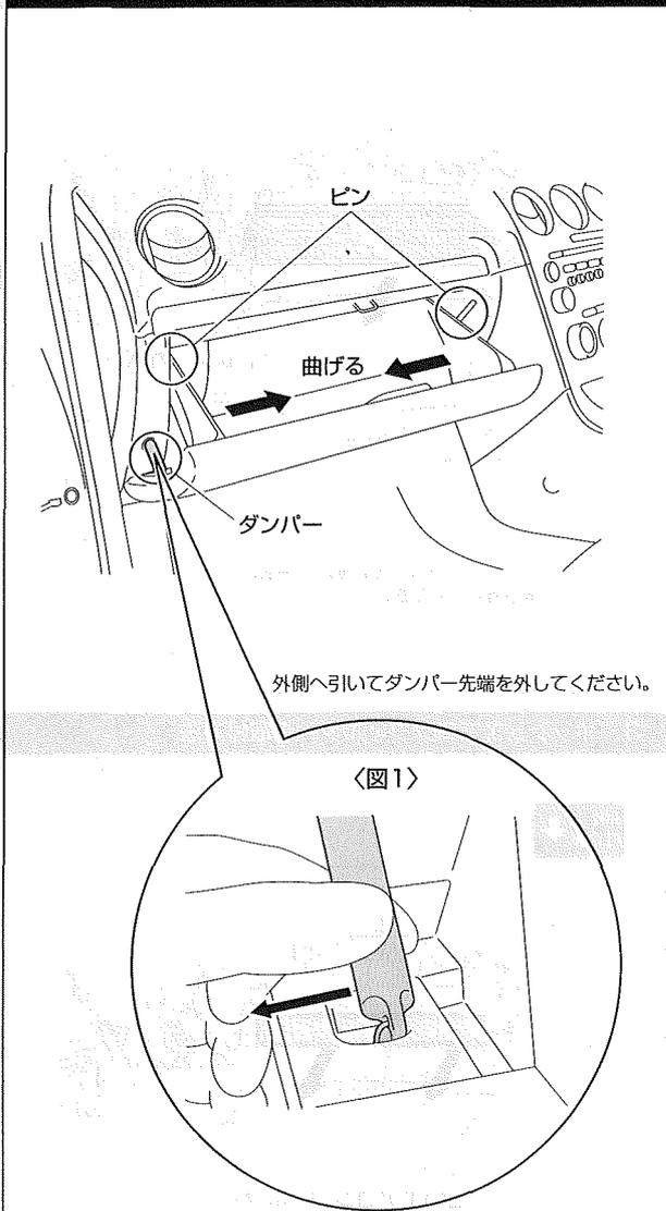
グローブボックスを開き、ピン（2箇所）とダンパーを外し（図1参照）グローブボックスを内側に曲げながら取り外してください。
