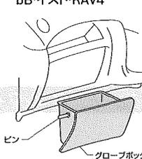
グローブボックスを開き、両側から押さえてピン(2箇所)を外し、グローブボックスを取り外してください。
