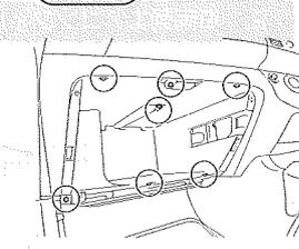
ネジ(7箇所)を外し、パネルを手前に引いて外してください。
