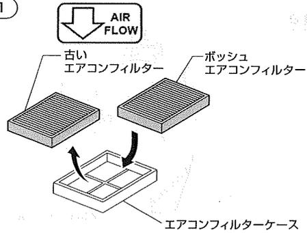
車両側の古いフィルターを取り外し、ボッシュ エアコンフィルターを「Air Flow の矢印」が下を向くようフィルターケースに組み付けてください。
