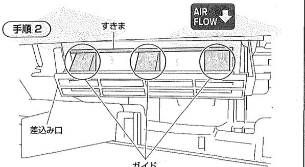
フィルターカバーを差込み口側から取り付け、ガイドをフィルター上のすきまに差込みながら取り付けください。取り外した車両側部品を復元し、交換ステッカーをグローブボックス内側に貼り付けてください。
