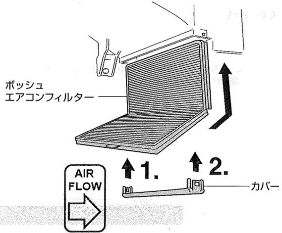
ボッシュ エアコンフィルターを「Air Flow の矢印」が右を向くよう挿入してください。
