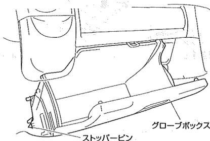
グローブボックスを開き、ストッパーピン(1箇所)を外し、グローブボックスを取り外してください。
