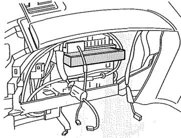
フィルターカバーを取り外し、古いエアコンフィルターを引き出して取り出してください。
