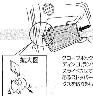
グローブボックス内側の左側面にあるピン(ディオン、ディンゴ、ランサーの場合、ピンは右側面)を手前にスライドさせて、取り外してください。ピンの反対側にあるストッパーを外側から内側へ押し、グローブボックスを取り外してください。
