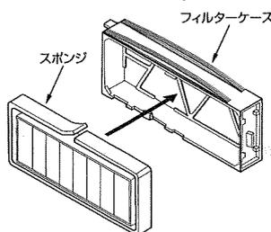
同梱のスポンジをフィルターの4面に貼り付けてください。車両側の古いフィルターを取り外し、エアコンフィルターを「Air Flow」の矢印が右を向くようフィルターケースに組み付けてください。取り外した車両側部品を復元し、交換ステッカーをグローブボックス内側に貼り付けてください。
