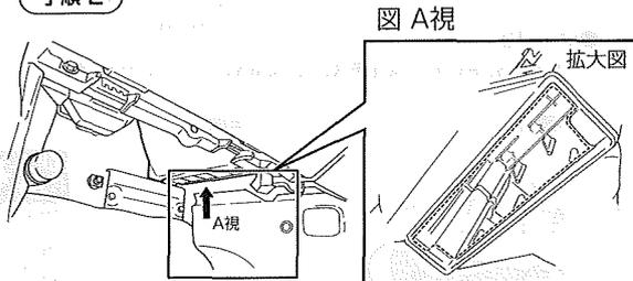
A視図点線を参考に、フィルター挿入口を淵に沿ってカッターなどで切り取ってください。
