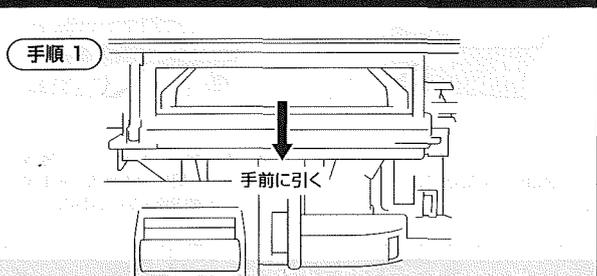
車両側の古いフィルターを取り外し、ボッシュ エアコンフィルターを「Air Flow」の矢印が下を向くようフィルターケースに組み付けてください。
