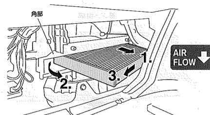
古いフィルターを図内の番号順に動かし、取り出してください。次に取り外しと逆の手順でボッシュエアコンフィルターを装着してください。取り外した車両側部品を復元し、交換ステッカーをグローブボックス内側に貼り付けてください。
