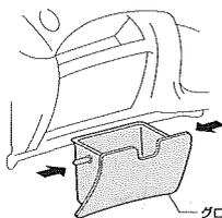
グローブボックスを開き、両側から押さえてピン(2箇所)を外し、グローブボックスを取り外してください。
