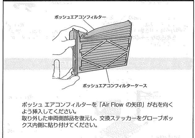
ボッシュエアコンフィルターを「Air Flow の矢印」が右を向くよう挿入してください。
