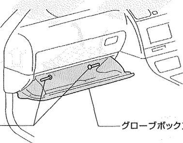
内側のピン (2箇所) を外し、グローブボックスを取り外してください。
