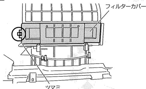
外したグローブボックス奥にあるフィルターカバーの左側のツマミをつまんで、フィルターカバーを取り外してください。
