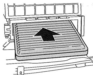
ボッシュ エアコンフィルターを「Air Flowの矢印」が下を向くよう挿入してください。
