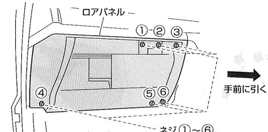
ネジ (6箇所) を外し、ロアパネルを手前に引いて取り出してください。エアバックコネクターがある場合は外してからグローブボックスを完全に取り外してください。
