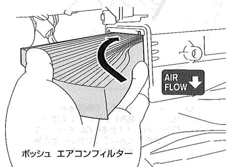
ボッシュ エアコンフィルターを「Air Flow の矢印」が下を向くよう挿入してください。
