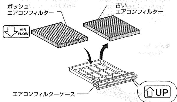
車両側の古いフィルターを取り外し、ボッシュ エアコンフィルターを「Air Flow」の矢印が下を向くようフィルターケースに組み付けてください。取り外した車両側部品を復元し、交換ステッカーをグローブボックス内側に貼り付けてください。
