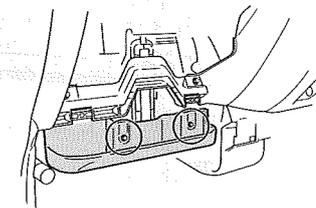
グローブボックスを開き、内側右側面のクリップ(1箇所)を番号順にスライドさせて外してください。左側のストッパーを外し、グローブボックスを取り外してください。
