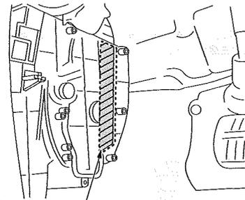
フィルター挿入口を、図のように点線に沿ってカッターなどで切り取ってください。
