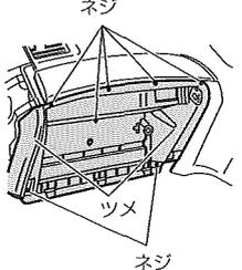
ネジ (7箇所)、ツメ (2ヶ所) を外し、カバーを取り外してください。
