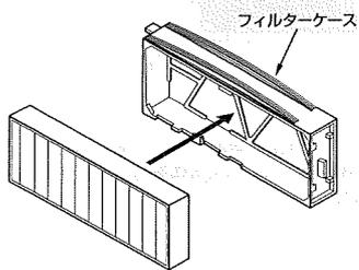
同梱のスポンジは不要です。車両側の古いフィルターを取り外し、エアコンフィルターを「Air Flow」の矢印が右を向くようフィルターケースに組み付けてください。取り外した車両側部品を復元し、交換ステッカーをグローブボックス内側に貼り付けてください。
