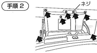
グローブボックスを開き、内側にあるネジ(7箇所)をドライバーなどで取り外してください。
