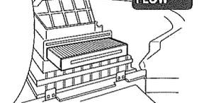
車両側の古いフィルターを取り外し、ボッシュ エアコンフィルターを「Air Flow の矢印」が下を向くよう挿入してください。取り外した車両側部品を復元し、交換ステッカーをグローブボックス内側に貼り付けてください。
