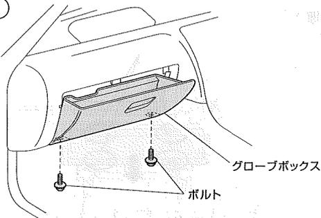
ボルト (2箇所) を外し、グローブボックスを取り外してください。
