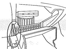
グローブボックス左側にあるダンパーのツメを外し、グローブボックス全体を手前に倒します。(パジェロの場合、ダンパーは右側)
