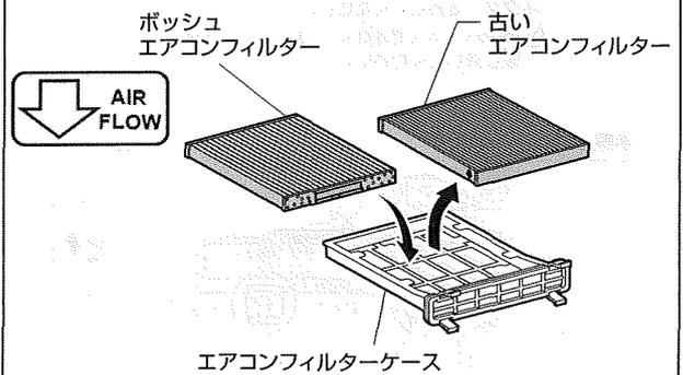
車両側の古いフィルターを取り外し、ボッシュエアコンフィルターを「Air Flow」の矢印が下を向くようフィルターケースに組み付けてください。
