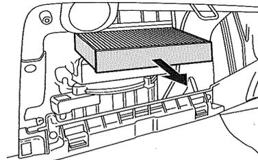
ボッシュ エアコンフィルターを「Air Flowの矢印」が下を向くよう挿入してください。
