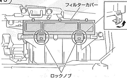
フィルターカバー(再使用します)下部のロックノブ(2箇所)を外し、フィルターカバーを取り外してください。
