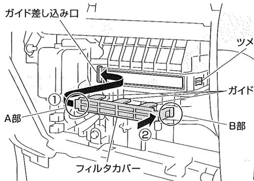
フィルターカバーA部を左差し込み口から取りつけ、次にB部をツメに引っ掛けてください。取り外した車両側部品を復元し、交換ステッカーをグローブボックス内側に貼り付けてください。
