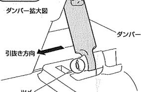
ダンパー装着車はダンパーをツメから引き抜き、グローブボックスを取り外してください。
