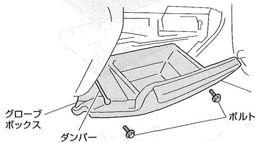
ボルト (2箇所) を外し、ダンパーを外してからグローブボックスを取り出してください。
