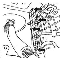
ネジ (4箇所) を外し、フィルターカバーを取り外してください。
