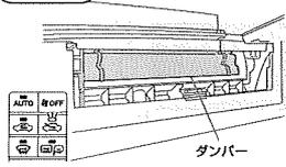
内外気切り替えスイッチを内気循環に切り替えてから作業してください。外気導入では図のようにダンパーが閉じているため交換できません。
