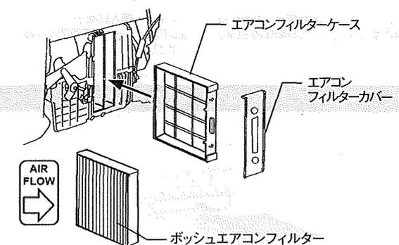
ポッシュ エアコンフィルターを「Air Flow」の矢印が右を向くようフィルターケースに組み付けてください。取り外した車両側部品を復元し、交換ステッカーをグローブボックス内側に貼り付けてください。
