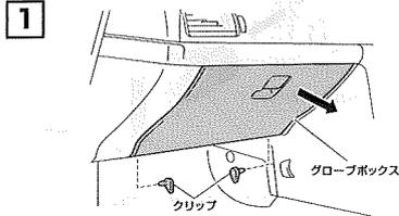
1 グローブボックス下側のクリップ (2箇所) を抜いて、グローブボックスを取り外してください。
