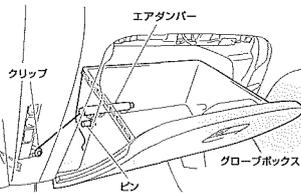
グローブボックスを開き、エアダンパーの固定クリップ(1箇所)を外してください。グローブボックス内のピン(2箇所)を外し、グローブボックスを取り外してください。
