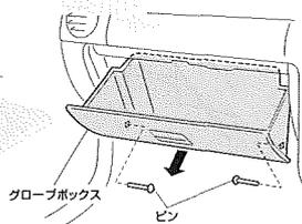
グローブボックスを開き、ピン(2箇所)を外し、グローブボックスを取り外してください。
