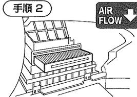
車両側の古いフィルターを取り外し、ボッシュ エアコンフィルターを「Air Flow の矢印」が下を向くよう挿入してください。取り外した車両側部品を復元し、交換ステッカーをグローブボックス内側に貼り付けてください。
