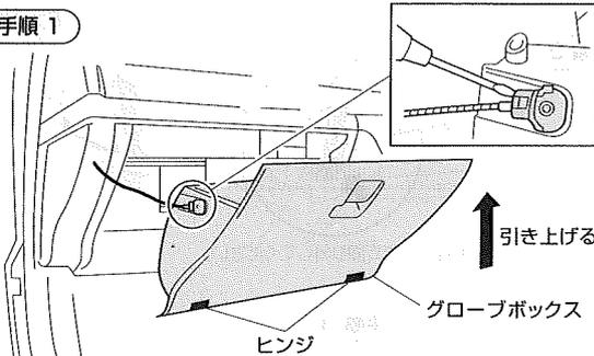
グローブボックスを上側へ引き上げ、ヒンジ (2箇所) を外してください。ダンパーがある場合は、マイナスドライバー等を使用し外してから、グローブボックスを取り外してください。
