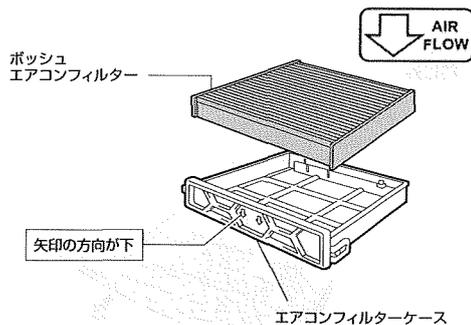
車両側の古いフィルターを取り外し、ボッシュエアコンフィルターを「Air Flowの矢印」が右を向くようフィルタートレーに組み付けてください。
