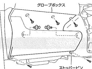
スクルー(5箇所)、ピン(2箇所)を外し、グローブボックスを取り外してください。
