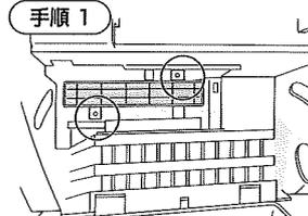
ネジ(2箇所)を外し、フィルターカバーを取り外してください。
