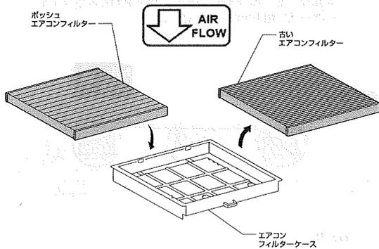
車両側の古いフィルターを取り外し、ボッシュ エアコンフィルターを「Air Flow」の矢印が下を向くようフィルターケースに組み付けてください。
