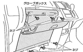
ネジ(6箇所)取り外し、グローブボックスを取り外してください。
