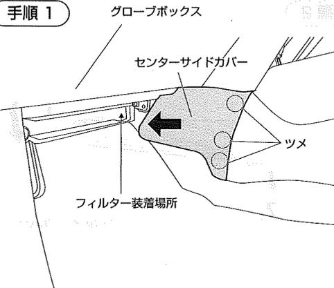
助手席側のセンターサイドカバーのツメ(3箇所)を折らないように外し、矢印の方向に押してカバーを外してください。
