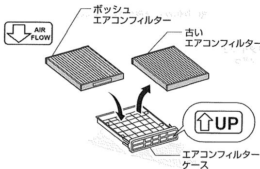
車両側の古いフィルターを取り外し、ボッシュ エアコンフィルターを「Air Flow の矢印」が下を向くようフィルターケースに組み付けてください。
