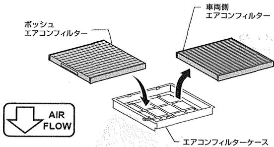
車両側の古いフィルターを取り外し、ボッシュ エアコンフィルターを「Air Flow」の矢印が下を向くようフィルターケースに組み付けてください。取り外した車両側部品を復元し、交換ステッカーをグローブボックス内側に貼り付けてください。
