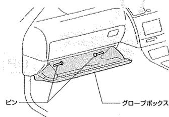
グローブボックスを開き、下側のピン(2箇所)を外し、グローブボックスを取り外してください。
