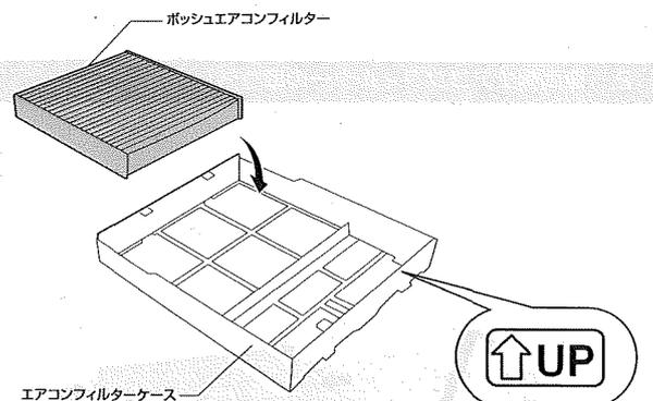
車両側の古いフィルターを取り外し、ボッシュエアコンフィルターを「Air Flow の矢印」が下を向くようフィルターケースに組み付けてください。
