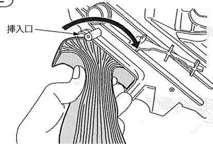
フィルターを挿入の際は図のように回し込むように挿入すると、作業しやすくなります。
