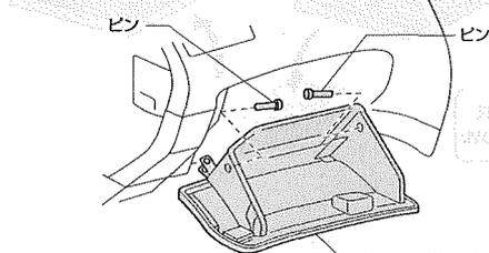
グローブボックスを開き、内側のピン(2箇所)を外し、グローブボックスを取り外してください。
