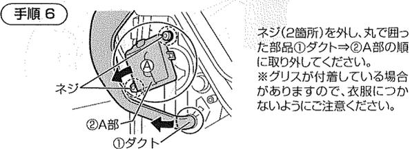
ネジ(2箇所)を外し、丸で囲った部品①ダクト⇒②A部の順に取り外してください。
