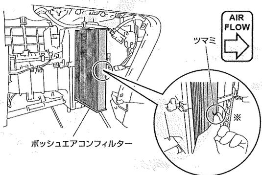
ボッシュ エアコンフィルターを「Air Flow の矢印」が右を向くよう挿入してください。取り外した車両側部品を復元し、交換ステッカーをグローブボックス内側に貼り付けてください。
