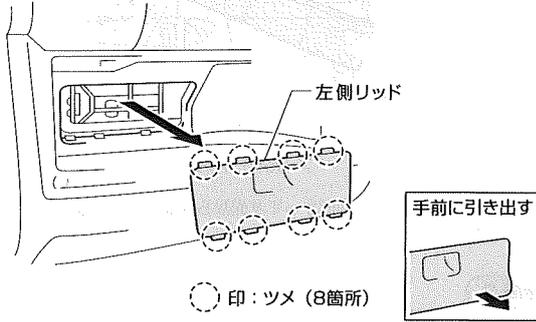
グローブボックス下にある左側リッドのツメ (8箇所) を外し、手前に引き出して下さい。
