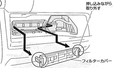
フィルターカバー左側をツメを押して手前に引き出してください。フィルターカバーを右奥に押し込み、手前に引き出してください。
