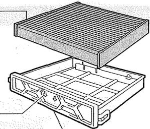
車両側の古いフィルターを取り外し、ボッシュエアコンフィルターを「Air Flow」の矢印が右を向くようフィルタートレーに組み付けてください。取り外した車両側部品を復元し、交換ステッカーをグローブボックス内側に貼り付けてください。
