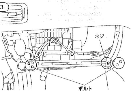
ボルト (4箇所)、ネジ (1箇所) を外し、フレームを取り外してください。
