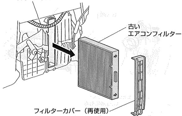
フィルターカバー (再使用します) を取り外し、車両側の古いフィルターを取り出します。
