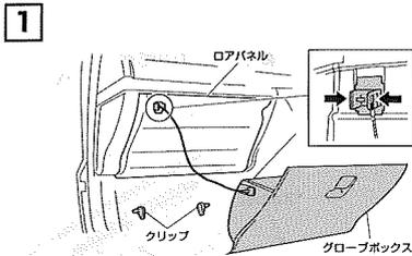
1 グローブボックス下側のクリップ (2箇所) を抜いて、グローブボックスを取り外し、ダンパーを矢印方向に引っ張ってください。
