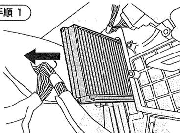
上側のフィルターを引き出してから、下側のフィルターを上げて引き出してください。
