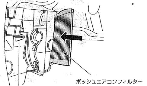
ボッシュ エアコンフィルターを「Air Flow の矢印」が右を向くよう挿入してください。
