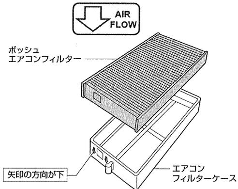
車両側の古いフィルターを取り外し、ボッシュエアコンフィルターを「Air Flow の矢印」が右を向くようフィルターケースに組み付けてください。
