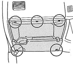
ネジ5箇所を外し、グローブボックスを取り外してください。
