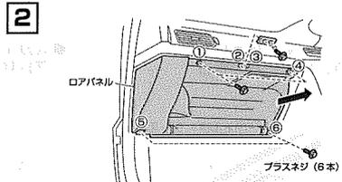
2 ネジ (6箇所) を外し、パネルを手前に引いて取り外してください。パネル外した後、ハーネス本体を持ってパネルから外してください。
