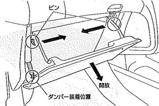
グローブボックスを開き、両側から押さえてピン(2箇所)を外し、グローブボックスを取り外してください。
