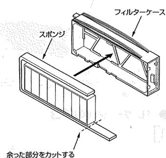
同梱のスポンジをフィルターの3面に貼り付け、余った部分をカットしてください。車両側の古いフィルターを取り外し、エアコンフィルターを「Air Flow」の矢印が右を向くようフィルターケースに組み付けてください。取り外した車両側部品を復元し、交換ステッカーをグローブボックス内側に貼り付けてください。
