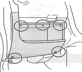
ネジ5箇所を外し、グローブボックスを取り外してください。
