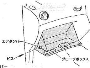
グローブボックスを開き、エアダンパーの固定ビス(1箇所)を外し、グローブボックスを取り外してください。
