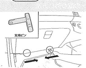
グローブボックスを閉じて下のピン(2箇所)を抜き、グローブボックスを取り外してください。
