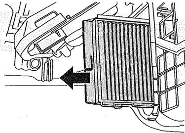
下側のフィルターを引き出してから、上側のフィルターを下げて引き出してください。
