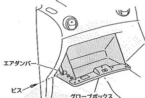
グローブボックスを開き、エアダンパーの固定ビス(1箇所)を外し、グローブボックスを取り外してください。
