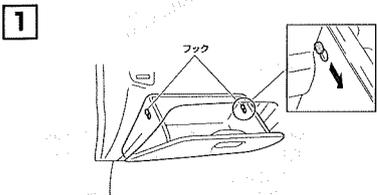
1 矢印の方向にフック (2箇所) を動かして、グローブボックスを取り外してください。
