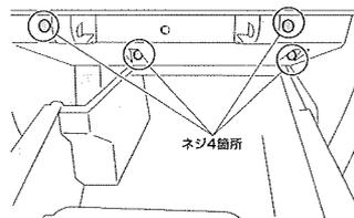
グローブボックスを最大限開き、ネジ(4箇所)を外し、グローブボックスとパネルごと手前に引いて取り外してください。
