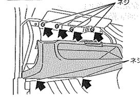
グローブボックスを開き、内側にあるネジ(6箇所)をドライバーなどで取り外してください。
