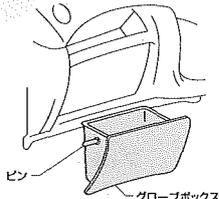
グローブボックスを開き、両側から押さえてピン(2箇所)を外し、グローブボックスを取り外してください。
