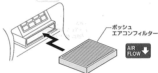
ボッシュエアコンフィルターを「Air Flow の矢印」が下を向くよう挿入してください。取り外した車両側部品を復元し、交換ステッカーをグローブボックス内側に貼り付けてください。
