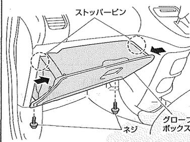
ネジ(2箇所)を取り外し、グローブボックスを開き、両側から押さえてストップバーピン(2箇所)を外してから、グローブボックスを取り外してください。
