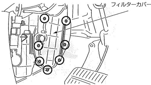
運転席の左側にあるフィルターカバーのネジ (7箇所) を外し、フィルタカバーを取り外してください。
