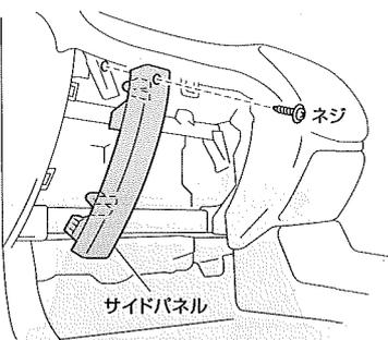
ネジ (1箇所) を取り外し、サイドパネルを取り外してください。
