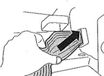
ボッシュ エアコンフィルターを「Air Flowの矢印」が右を向くよう挿入してください。
