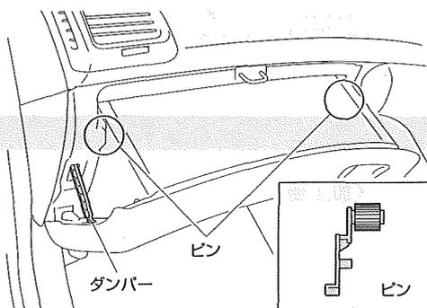
グローブボックスを開き、ピン (2箇所) を押し出し、ダンパーを外してからグローブボックスを取り外してください。
