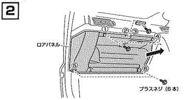
2 ネジ (6箇所) を外し、パネルを手前に引いて取り外してください。パネル外した後、ハーネス本体を持ってパネルから外してください。
