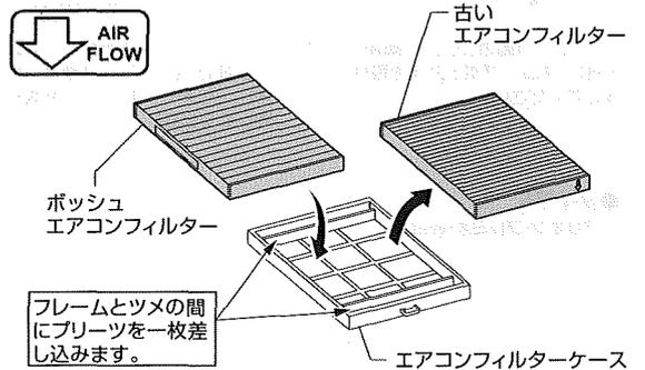
車両側の古いフィルターを取り外し、ボッシュエアコンフィルターを「Air Flowの矢印」が下を向くようフィルターケースに組み付けてください。
