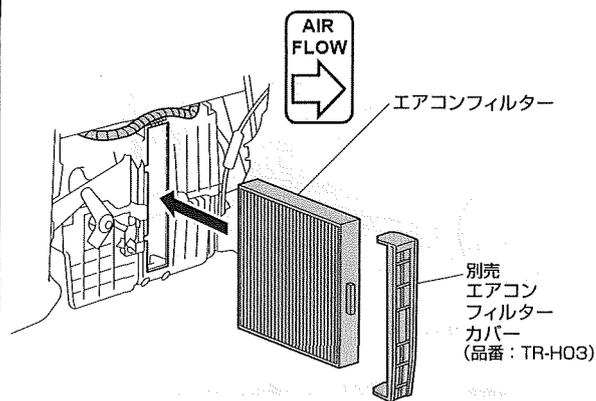
ボッシュ エアコンフィルターを「Air Flow の矢印」が右を向くようにし、ハーネスをキズつけないよう注意して挿入してください。
