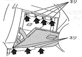
グローブボックスを開き、内側にあるネジ(7箇所)をドライバーなどで取り外してください。
