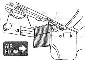
ボッシュ エアコンフィルターを「Air Flow の矢印」が右を向くよう挿入してください。取り外した車両側部品を復元し、交換ステッカーをグローブボックス内側に貼り付けてください。
