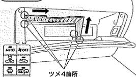
グローブボックスを開き、仕切り板を矢印方向へずらし、ツメを外してからグローブボックスを取り外してください。
