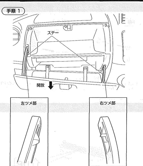
グローブボックスを開き、左右のステアのツメの引っかかりを通過させ、グローブボックスを取り外してください。
