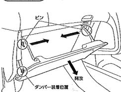
グローブボックスを開き、両側から押さえてピン(2箇所)を外し、グローブボックスを取り外してください。
