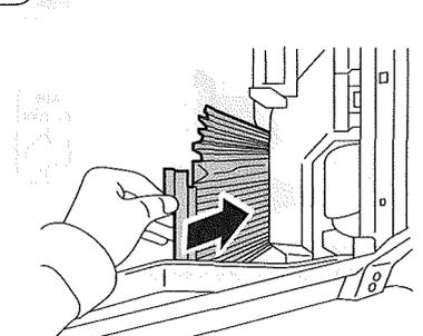
ボッシュ エアコンフィルターを「Air Flowの矢印」が右を向くよう挿入してください。
