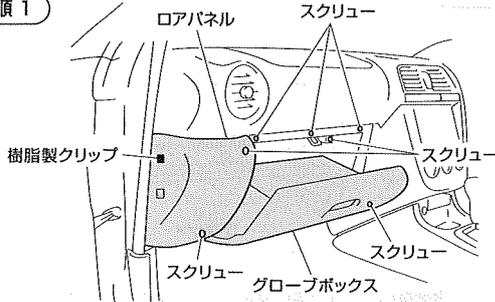
スクリュー(7箇所)、樹脂製クリップ(1箇所)を外し、グローブボックスおよびロアパネルを外してください。
