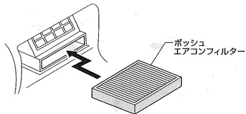
取り外した車両側の部品を復元し、交換ステッカーをグローブボックス内側に貼り付けてください。
