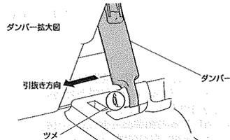
ダンパー装着車はダンパーをツメから引き抜き、グローブボックスを取り外してください。
