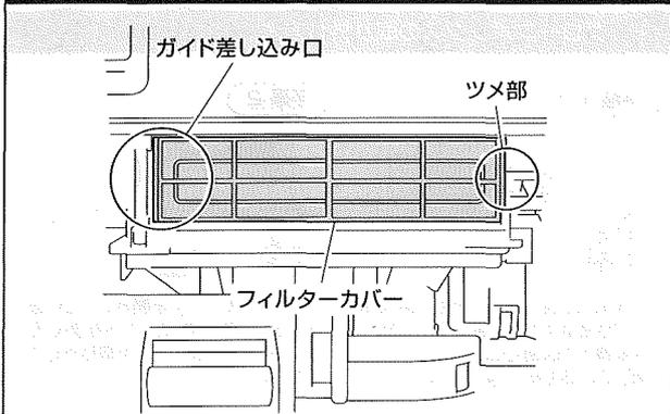
フィルターカバー右側のツメを外し、ガイド差し込み口から取り外してください。
