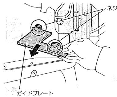
助手席側の足元、右側にあるネジ(4箇所)をドライバーなどで取り外し、ガイドプレートを外してください。
