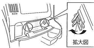
グローブボックスを開け、グローブボックス内側にあるストッパー(左右2箇所)を引き起こし、取り外してください。
