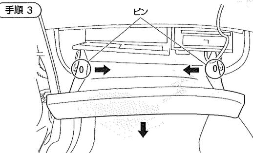
グローブボックス両側を内側へ曲げながらピンの引っかかりを通過させ、取り外してください。
