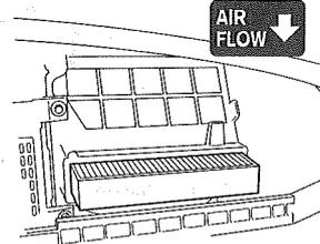
車両側の古いフィルターを取り外し、ボッシュ エアコンフィルターを「Air Flow の矢印」が下を向くよう挿入してください。取り外した車両側部品を復元し、交換ステッカーをグローブボックス内側に貼り付けてください。
