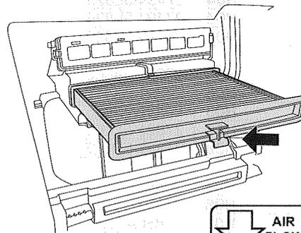
ボッシュエアコンフィルターを「Air Flow」の矢印が下を向くよう挿入してください。
