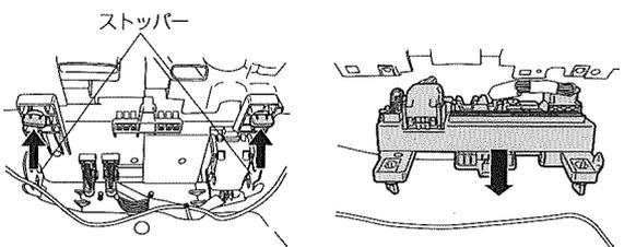
ヒューズボックスのストッパー (2箇所) を回して解除し、右図のようにヒューズボックスを下にずらしてください。
