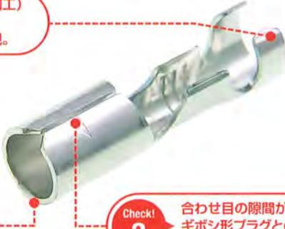
**Check! 3** 合わせ目の隙間が狭いため、ギボシ形プラグとの密着性向上。(接触面積が"大"=高導電)
