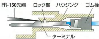
ハウジングに引抜き工具の先端を挿入し、ターミナルを固定しているハウジングのロック部を持ち上げながら、ケーブル(ターミナル)を引抜きます。
