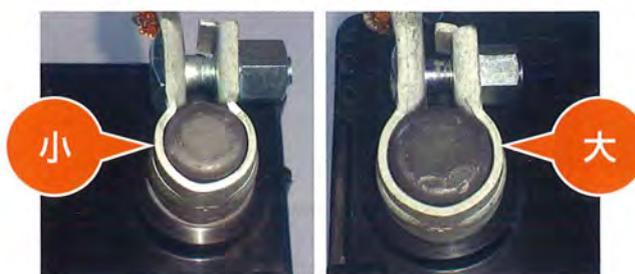
車に搭載されているバッテリーの端子が**小ポール**で、新しく取り替えるバッテリーが**大ポール**（電気容量が大きいタイプ）の場合
