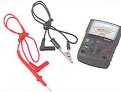
直流電圧測定・導通テスト・乾電池チェックに
