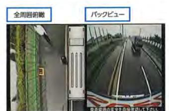
複数の車載カメラから映し出した画像を俯瞰画像として、車内のモニターへ表示。ドライバーにとって死角となってしまう部分を映し出し、安全走行をサポートします。
