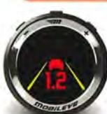
時速30km以上で走行中、前方車両との車間距離を秒数(車間距離÷車両の速度)で表示します。事前に設定した秒数よりも車間距離が短くなると、「ピン」という警告音とアイコン表示で警告します。
