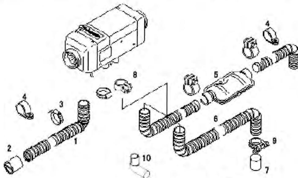
燃焼用空気・排気システム
