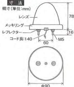
● 梱包：小箱10個/大箱100個 ● 主材質：[レフレクター]PP・鉄/[リング]ABS(クロームメッキ)/[レンズ]アクリル
