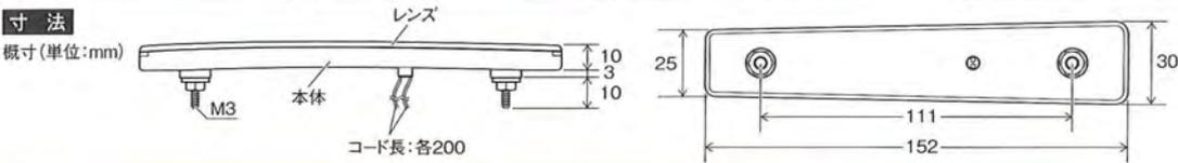
※車両コードと接続する箇所から本製品に水が浸入するおそれがあります。接続部の防水処理を確実に行ってください。
