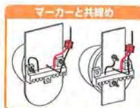
スポット光で地面を照らす ネジピッチ60mmのマーカランプへ装着可能。
