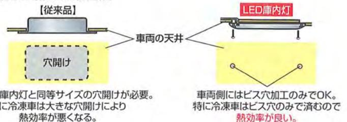
車両側に庫内灯と同等サイズの穴開けが必要。特に冷凍車は大きな穴開けにより熱効率が悪くなる。
