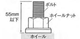
ホイールからボルトの先端までの高さが55mm以下の車種に取り付けできます。
